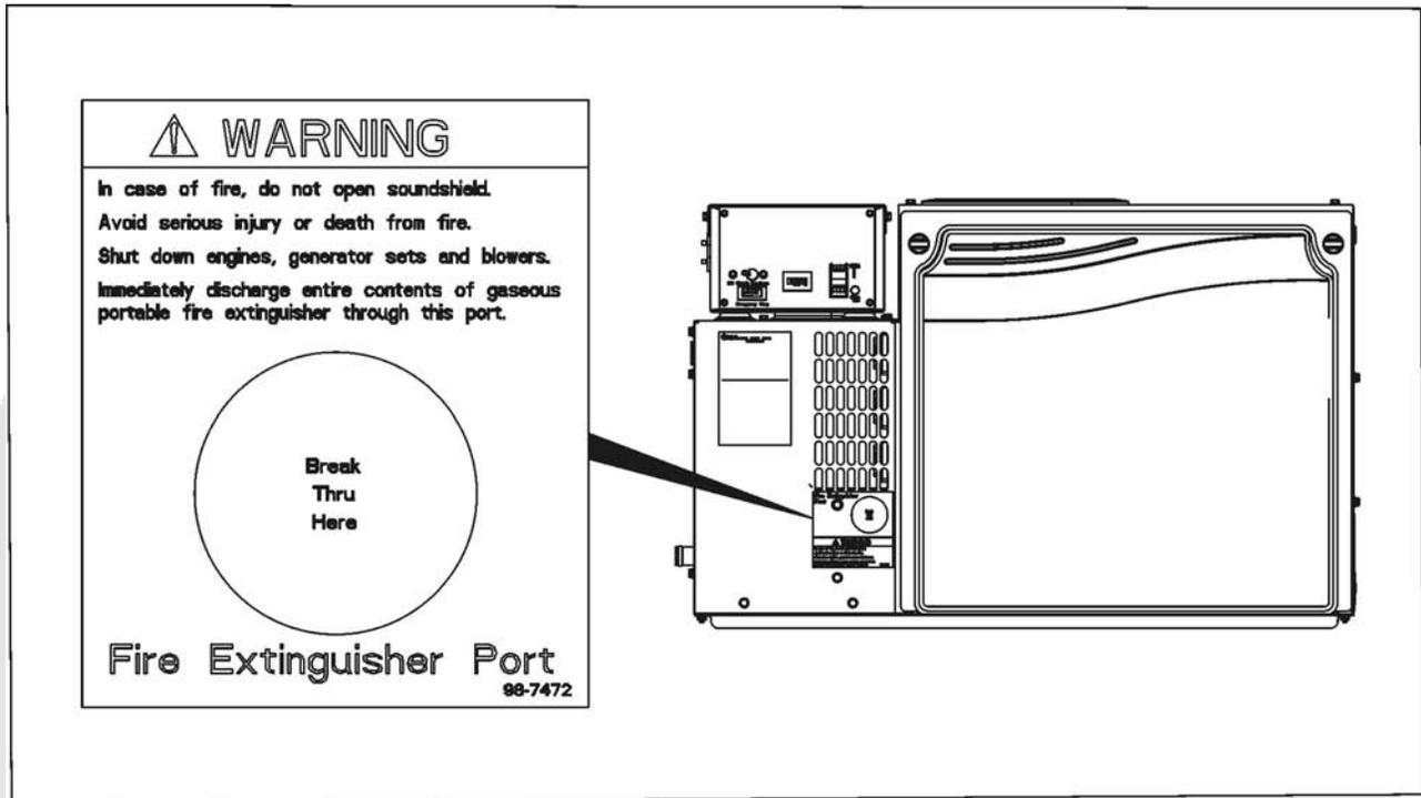
FIGURE 12. FIRE EXTINGUISHER PORT LABEL LOCATION
