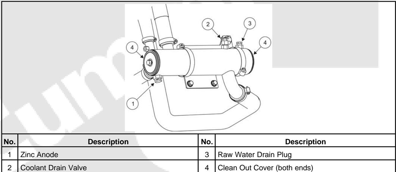
**FIGURE 22. HEAT EXCHANGER**
