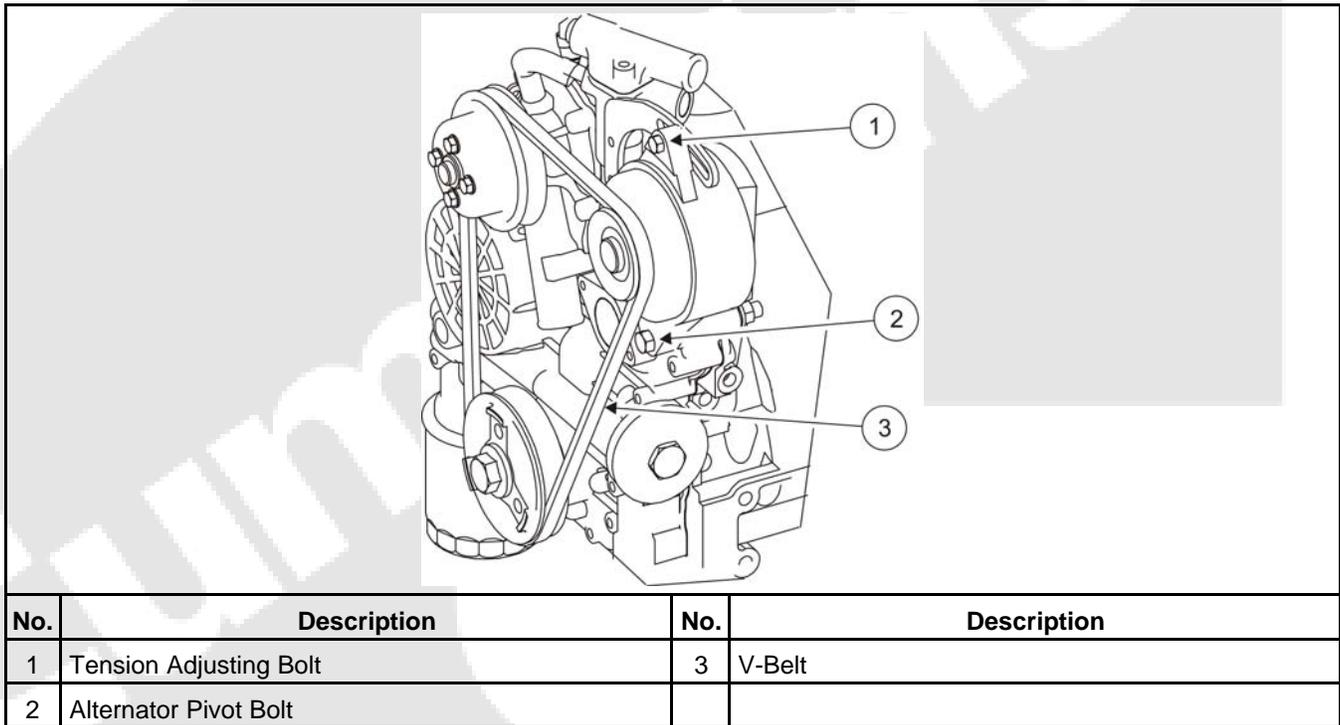
FIGURE 25. ADJUSTING V-BELT TENSION
