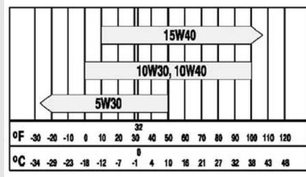
FIGURE 17. OIL VISCOSITY VS. AMBIENT TEMPERATURE
